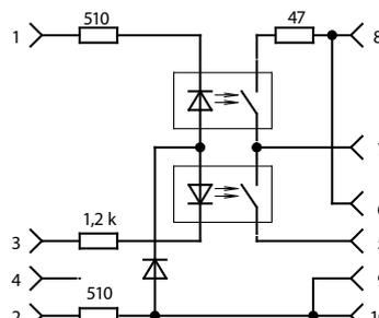
Рисунок 4 - Схема модуля МС-01
